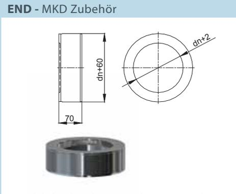
zum Abdecken der Isolierung zwischen Aussen- und Innenrohr, für den waagerechten Bereich
