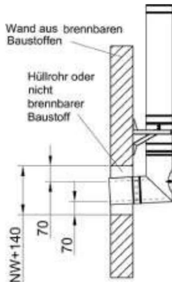
Bei Wänden aus oder mit brennbaren Baustoffen muss bei Durchführung der Therm-AGL im Umkreis von mind. 7 cm vom Innenrohr gemessen, die Durchführung aus nichtbrennbaren, formbeständigen Baustoffen geringer Wärmeleitfähigkeit z.B. Leichtbeton hergestellt werden. Der Sicherheitsabstand kann auch durch ein Schutzrohr gewährleistet werden. Er darf auf 5 cm verringert werden, wenn die Abgastemperatur 160° nicht überschreitet.
