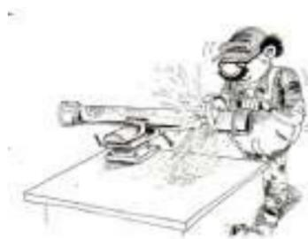
Sofern möglich (beim Übergang auf die einwandige Abgasverbindungsleitung), können einwandige Rohrelemente auch vor Ort auf die gewünschte Länge gekürzt werden.
